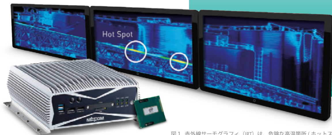
図1. 赤外線サーモグラフィ (IRT) は、危険な高温箇所 (ホットスポット) を検出し装置の故障を予防するために使用できます。
